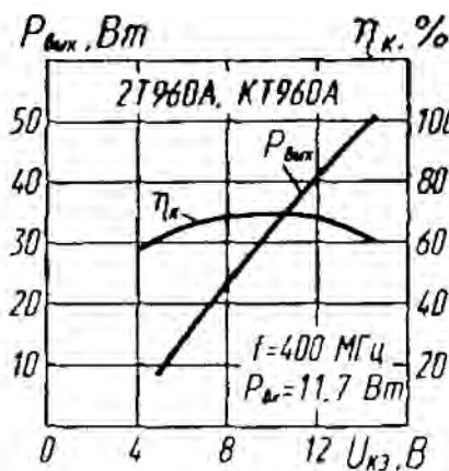
Зависимости выходной мощности и коэффициента полезного действия от напряжения коллектор—эмиттер
