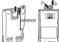
При необходимости присоедините поясную клипсу. Для снятия клипсы нажмите на пружинный зажим 1 на ней и потяните клипсу вверх из гнезда 2.
